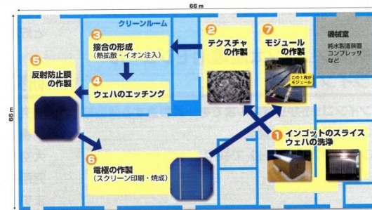
薄型結晶シリコン太陽電池(セル・モジュール)の一貫製造ライン
