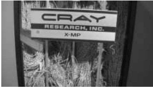
コードが張り巡らされたクレイ社の初期のスーパー・コンピュータ
