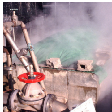
・蒸気消毒槽(温泉蒸気で土壌・資材を消毒) (大分県農林水産研究指導センター花きグループ)
