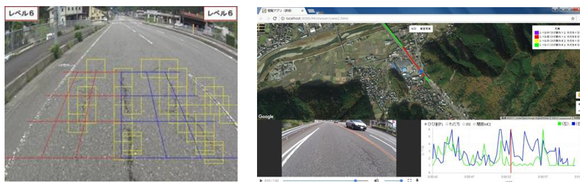
図 5.4.3 わだち割れ検出のイメージ（左）と舗装損傷診断システムの利用イメージ（右）
