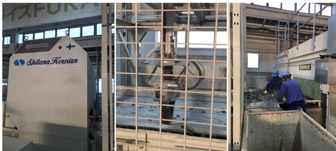
素材選別スキャナ (左) / ロボットアームによる分類 (中央) / 最終目視チェック (右)
