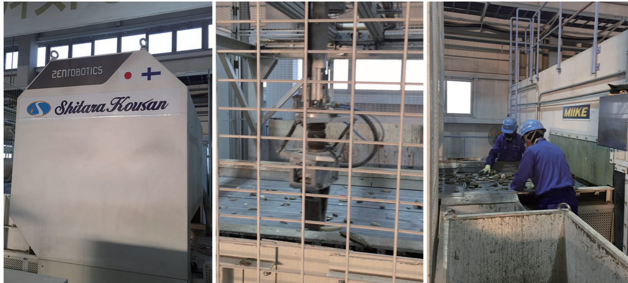
図7 産業廃棄物処理工場での人工知能×ロボット導入例（シタラ興産） ※筆者らが撮影
